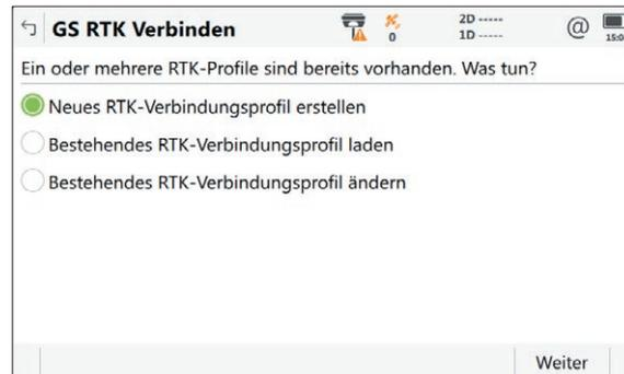
Nach der Bestätigung durch **Weiter** können Sie einen eindeutigen Namen (bspw. AXIO-NET) vergeben. Sollten Sie häufiger mit unterschiedlichen Mountpoints arbeiten, lohnt die Einrichtung eines separaten Verbindungsprofils für den jeweiligen Mountpoint.
