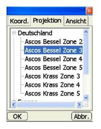
Wählen Sie unter **Deutschland** die für Sie zutreffende Gauss-Krüger-Zone aus und wechseln Sie anschließend zum Reiter:
