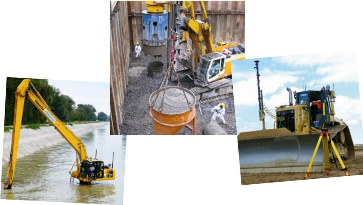
Mithilfe von ascos-Korrekturdaten und den richtigen Sensoren lassen sich nicht nur unter Wasser höchste Genauigkeiten erzielen (links). Auch Bohrgestänge für Bodensanierungen lassen sich zentimetergenau positionieren (Mitte). Die Virtual Base der ALLSAT ermöglicht die Überbrückung von Funklöchern, die aufgrund des Geländeprofiles auftreten können (rechts).
