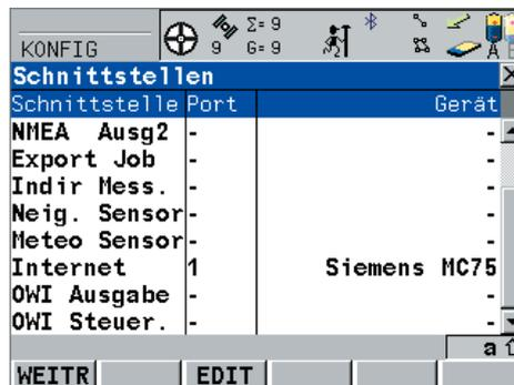
Hier wird der **Instrumentenport**, an dem das für die GPRS Verbindung nötige Gerät angeschlossen ist, ausgewählt. Mit **F5 GERÄT** wählen Sie das Gerät selbst aus.
