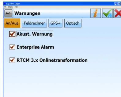
Bei der GNSS-Messung einen „**Mountpoint**“ auswählen, bei dem die RTCM-Online-Transformationen übertragen werden (z.B. Mountpoint: „**13-AXIO**“).
