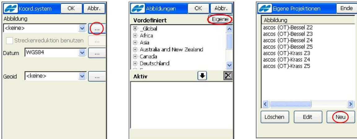
Durch Anklicken der Schaltflächen **Eigene** und dann **Neu** kann eine neue Abbildung definiert werden. Im folgenden Beispiel wurde eine bestehende Abbildung (ascos (OT)-Bessel Z3) editiert um die Einstellungen besser erläutern zu können.
