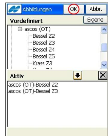
Zur Benutzung der Online-Transformation in TopSURV, unter „Projekt“ → „Optionen“ → „Koordinatensystem“ mit der Pfeiltaste die gewünschte Abbildung auswählen. Die zugehörige Datumsdatei wird automatisch gesetzt. Die Schaltfläche OK übernimmt die Einstellungen und schließt das Fenster.
